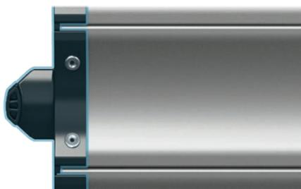
**Windschutzhaken** – werden als Standardausrüstung bei Toren mit einer Breite von mehr als 5.000 mm verwendet. Für schmalere Tore können sie als zusätzliche Option genutzt werden. Tore mit Windschutzhaken besitzen grundsätzlich Windwiderstandsklasse 3.
