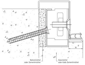
Indirekte Montage durch Vorzarge El30
