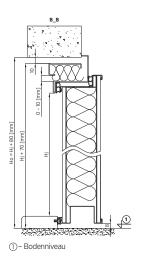
Vertikalschnitt von Türen ENIRO mit Vorzarge – Montage vor der Öffnung
