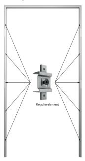
Die Türen können optional mit einer speziellen Vorzarge ausgestattet werden, die die Montage erleichtert. Die Vorzarge besteht aus verzinktem Stahlblech mit einer Stärke von 1,5 [mm] und wird mit zehn Flachkopfschrauben direkt an der Wand befestigt.
